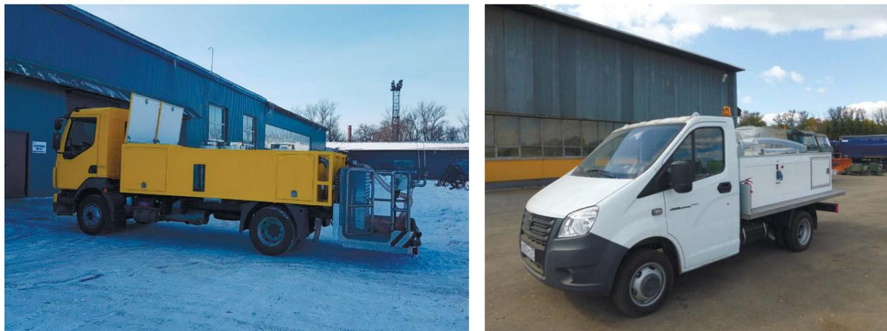
Машина для обработки туалетных отсеков ВС М0Т-01 предназначена для обслуживания туалетных отсеков всех типов воздушных судов. Баки для отходов, воды и дезжидкости выполнены из нержавеющей стали. Спецоборудование смонтировано на автомобильном шасси. Спецоборудование смонтировано на автомобильном шасси. Для удобного и безопасного обслуживания ВС в задней части машины может быть установлена гидравлическая подъемная кабина во всю ширину спецмашины.
