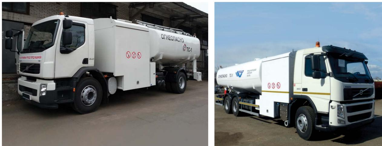
ТЗА предназначен для транспортирования авиационного топлива и заправки воздушных судов отфильтрованным и обезвоженным авиационным топливом: ТС-1 и РТ, Jet A-1, Jet A с возможностью дозированного ввода противоводокристаллизационной жидкости (ПВКЖ). ТЗА предназначен для эксплуатации в аэропортах «вне класса», 1, 2 и 3 классов, а также в международных аэропортах гражданской авиации, в зоне умеренного климата при температуре окружающего воздуха от -40°C до + 50°C.
