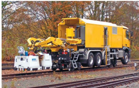
Предназначена для сварки железнодорожных рельс сечением до 12000 мм<sup>2</sup>.
