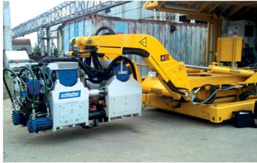
Предназначена для сварки железнодорожных рельс сечением до 10 000 мм<sup>2</sup>.
