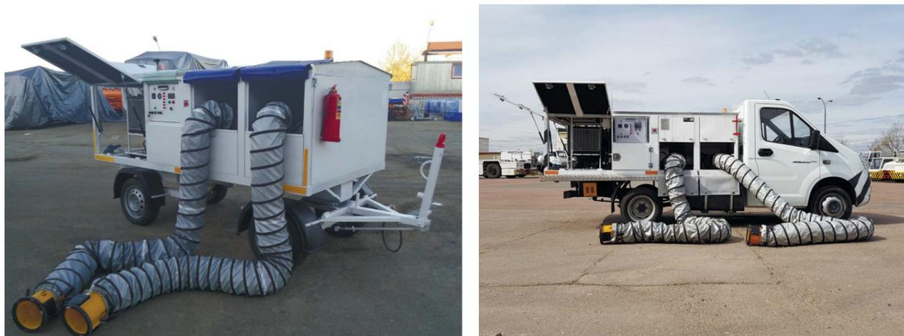
Универсальный мобильный подогреватель ВС с дизельным приводом (УМП), предназначен для быстрого разогрева двигателей ВС, подачи в салон ВС нагретого воздуха с температурой не более 60°C, осуществления вентиляции салона ВС (подача не нагретого воздуха). Предназначен для работы со всеми типами воздушных судов иностранного и отечественного производства.
