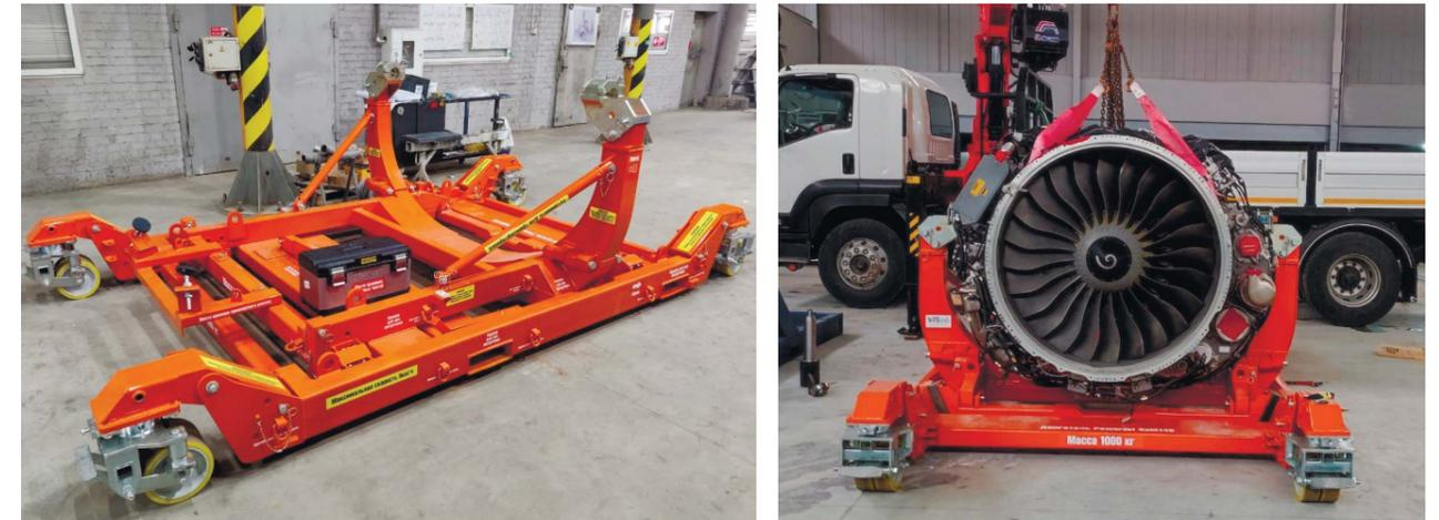
Данная линейка продукции предназначена для транспортировки, хранения и установки авиационных двигателей, а также их обслуживания и перемещения в ремонтной зоне авиапредприятия. В настоящий момент производятся стелы и траверсы для двигателей SaM146, ПД-8 и General Electric. Возможна разработка и производство стел под любой тип авиационных двигателей.
