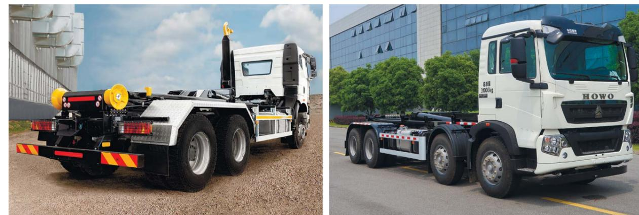
Крюковой погрузчик является одним из транспортных средств для перевозки отходов на дальние расстояния на сортировочные станции или на мусорные полигоны. Погрузку и разгрузку контейнера и выгрузку отходов может выполнять только водитель, находясь на автомобиле или выходя из него.
