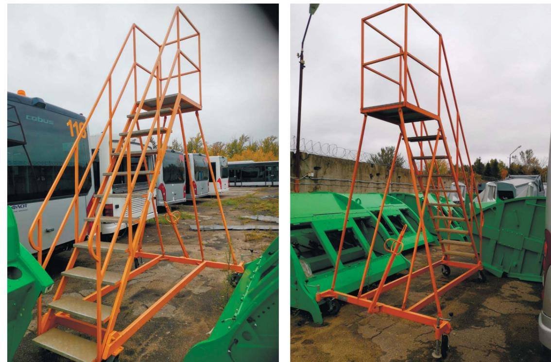
Предназначена для обеспечения доступа обслуживающего персонала к высоко расположенным узлам при проведении регламентных работ и технического обслуживания летательных аппаратов на местах стоянок, в крытых доках и ангарах.
