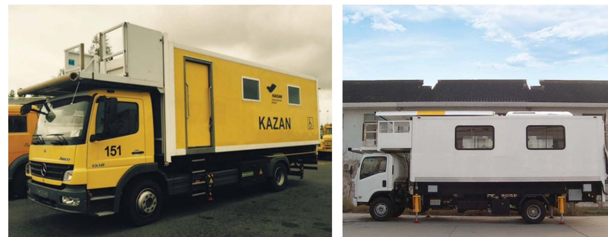
Амбулаторный автолифт предназначен для перевозки и погрузки в самолёт пассажиров с ограниченными возможностями. Подходит для обслуживания ВС с порогом от 2550 мм до 5600 мм. Автолифт состоит из шасси автомобиля, кунга подъемного ножничного механизма, передней и задней платформы, а также гидравлической и электрической систем.
