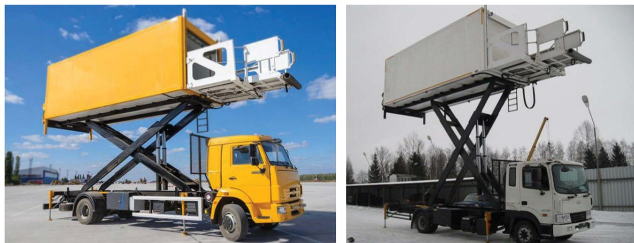
Кейтеринговый автолифт предназначен для перевозки и погрузки в самолёт контейнеров с бортопитанием для пассажиров, либо бытового оборудования. Он предназначен для обслуживания ВС с порогом от 2550 мм до 5600 мм. Автолифт состоит из шасси автомобиля, кунга подъемного ножничного механизма, передней и задней платформы, а также гидравлической и электрической систем.
