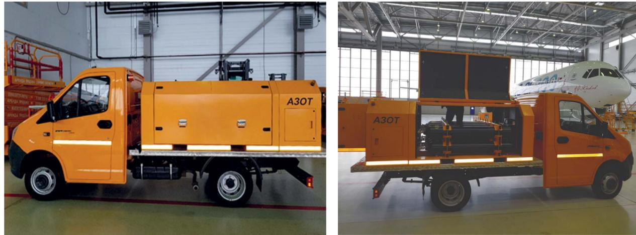
Линейка азотозаправочных и кислородозаправочных машин производства АО «ЗСТ» включает в себя как прицепные установки, так и на базе автомобильных шасси. Установки оборудованы стандартными баллонами объемом 40л, а также бустером, обеспечивающим стабильную и продолжительную работу установок.
