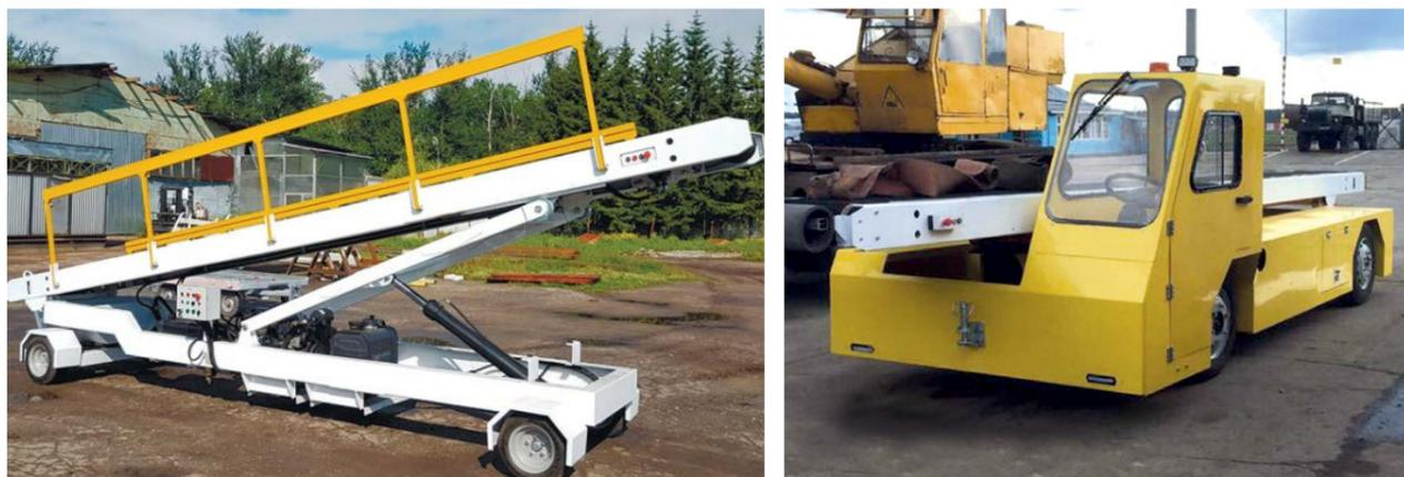
Аэродромный ленточный транспортер АЛТ-01 предназначен для погрузки багажа и грузов на борт воздушных судов, имеют стрелу с регулируемой высотой подъема. Ленточные транспортеры производятся как в прицепном исполнении, так и в самоходном с закрытой обогреваемой кабиной оператора и гидростатическим типом привода.
