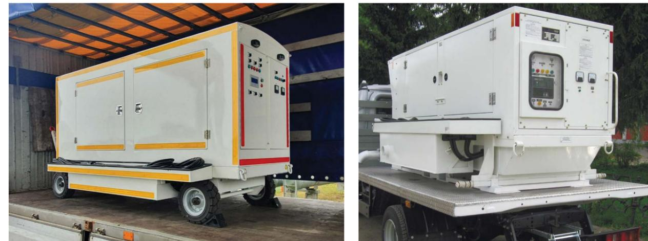
АПА представляет собой модуль со специальным оборудованием, смонтированный на двухосной телеге с водилом и стояночным тормозом. Предназначен для электропитания переменным и постоянным током бортового оборудования ЛА, а также обеспечения электростартерного запуска двигателей ЛА при наземном обслуживании.
