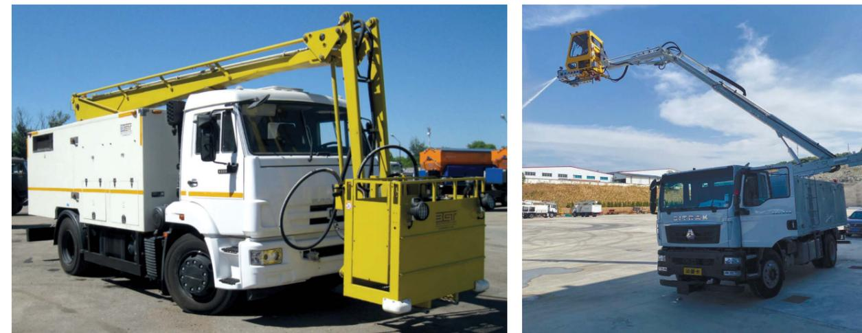
Предназначена для удаления льда и предотвращения обледенения на поверхностях всех типов воздушных судов. Возможно исполнение на различных марках шасси.
