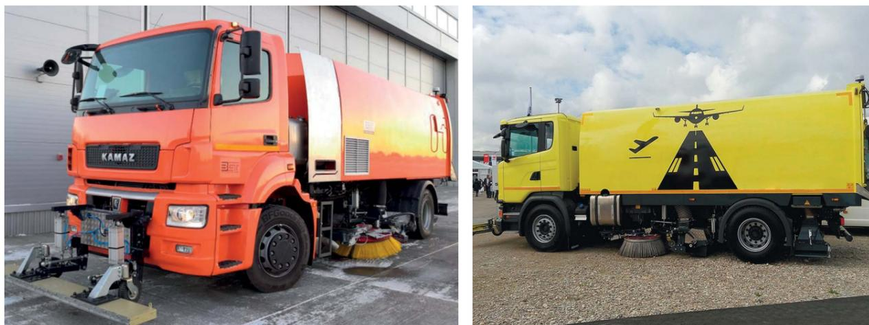
Машина предназначена для высокопроизводительной очистки искусственных покрытий аэродрома в летний период, а также опционально может использоваться для сбора ПОЖ, воды и снега с твердых поверхностей перрона. Контейнер для сбора мусора от 9м<sup>3</sup>. Бак для воды от 2000 л. Всасывающая шахта высокой производительности. Может комплектоваться лотковыми щетками, задним всасывающим рукавом и мойкой высокого давления.
